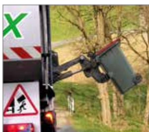
automatisiertes Entleeren ohne Personal
